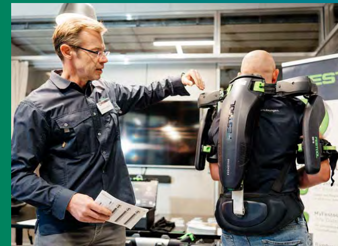
Das akkubetriebene Exoskelett ExoActive von Festool erleichtert das anstrengende Über-Kopf-Arbeiten und entlastet Nacken sowie Arme.
